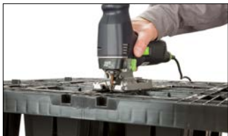
Découpe d'un élément en suivant le guide
