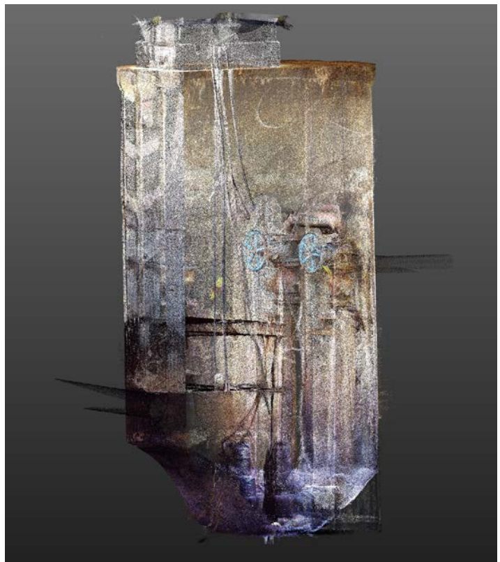
Pumpenschacht DN 2000 mit Doppelpumpanlage
