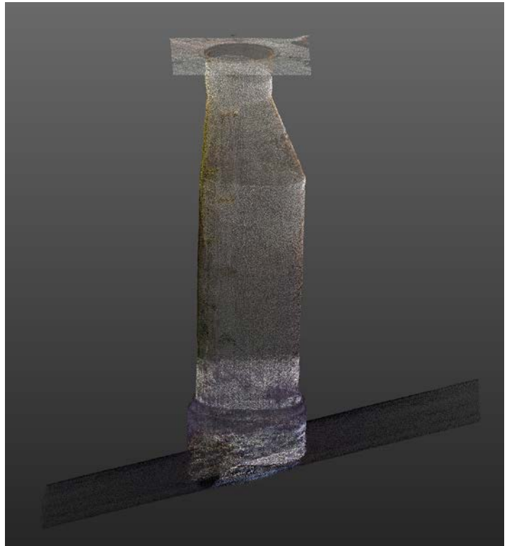
4m tiefer, gemauerter Schachtboden mit Betonringen und Konus
